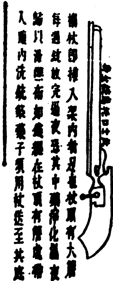
此乃銃架內面 每道銃放完通夜恐其中藥淨化通夜 歸以清煙布如處繩在杖頂有膠處帶 入腹內洗銃藥子須用杖透至其底
