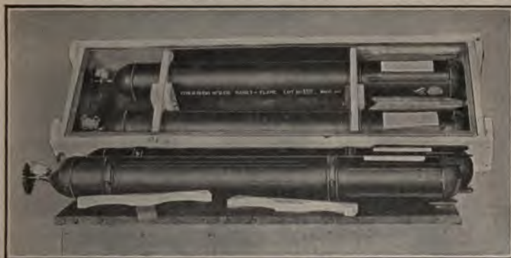
FIG. 128.—Boxing completed aéroplane flares.
